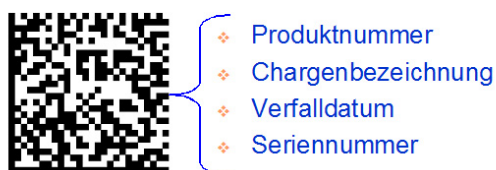
Bild 1: DataMatrix-Code mit Dateninhalt
