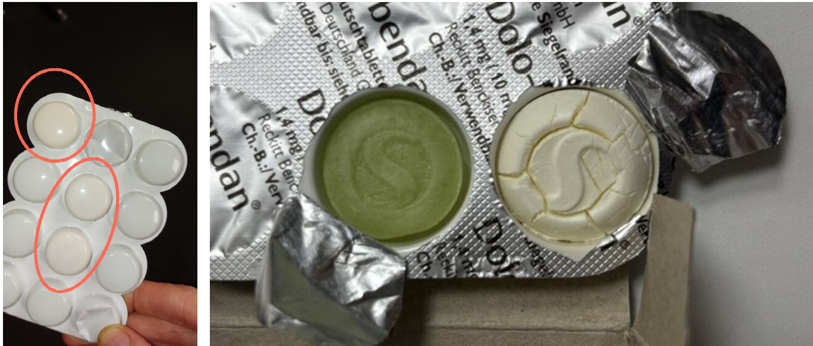
Abbildung: Links sind durch den Blister durchscheinend farblich veränderte Lutschtabletten (rot eingekreist) erkennbar; rechts sind von Weißverfärbung betroffene Lutschtabletten mit Volumenzunahme und matter, rauer und spröder Oberfläche mit Rissbildung im Vergleich zu ordnungsgemäßen Lutschtabletten abgebildet. Die intakte Tablette zeigt sich homogen grün gefärbt mit glatter, rissfreier Oberfläche und Prägung. (Foto © AMK)
