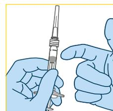
7. Um alle Bläschen zu entfernen und überschüssiges Arzneimittel auszustossen, die Kolbenstange langsam drücken, um die Basis des kuppelförmigen Kolbens (nicht die Spitze des Kolbens) an der schwarzen Dosierungslinie auf der Spritze auszurichten (entspricht 50 µl, das heisst 2 mg Aflibercept).
