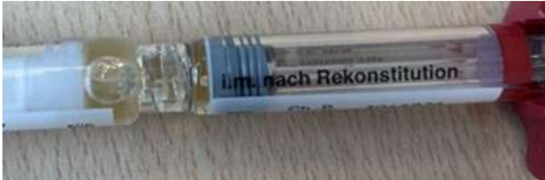
Abbildung 1: Reklamationsmuster mit Rissbildung an der Spritzenverbindung infolge Überdrehens beim Verschrauben
