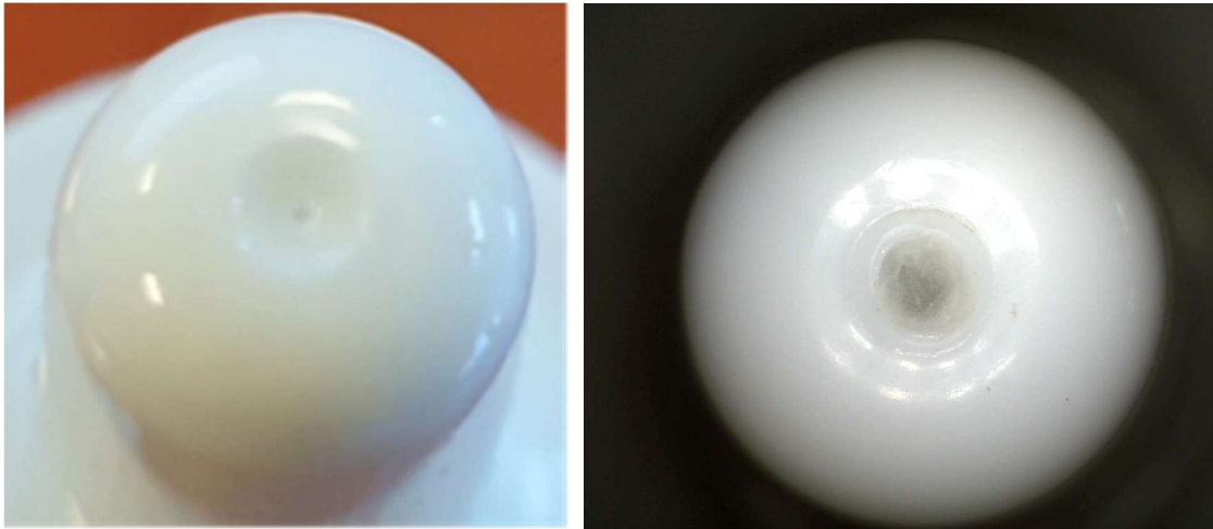
Abbildung: Die Abbildung links zeigt einen intakten Sprühkopf, rechts einen Sprühkopf nach Manipulation. (Foto © AMK)
