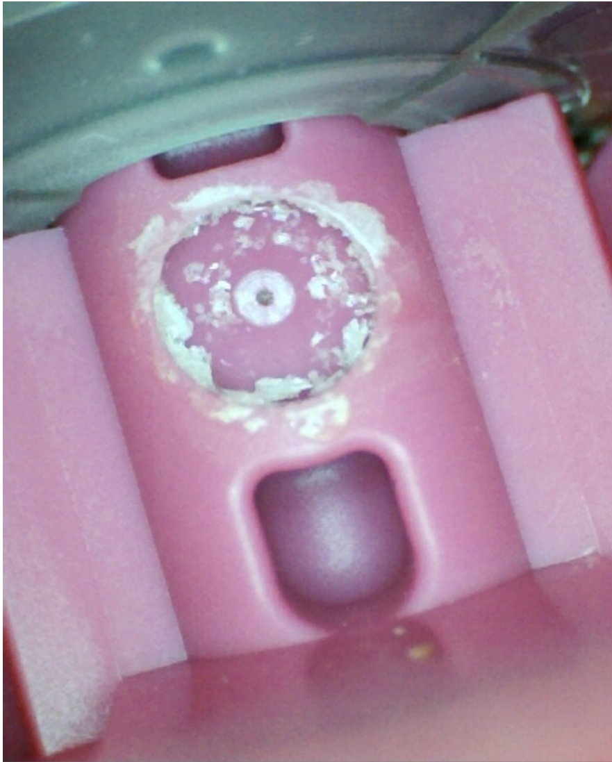
Abb. 3: Blick auf die Austrittsöffnung im Mundstück von Foster Dosieraerosol. In der Vertiefung, in der mittig die Austrittsöffnung liegt, sind weiße kristalline Ablagerungen zu erkennen. Auch die Düse ist mit Kristallen verstopft. Oben links umschließt das Zählwerk manschettenartig innenliegende Bauteile
