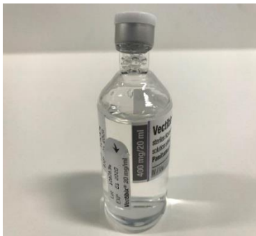
Abbildung 1: Durchstechflasche mit schief sitzendem Elastomerstopfen und Aluminiumverschluss
