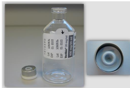
Abbildung 2: Durchstechflasche mit Aluminiumverschluss und Elastomerstopfen, die abgingen, als die abnehmbare Plastikkappe entfernt wurde
